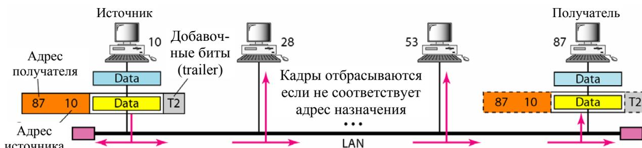
Рис. 2.21. Пример доставки на уровне передачи данных
