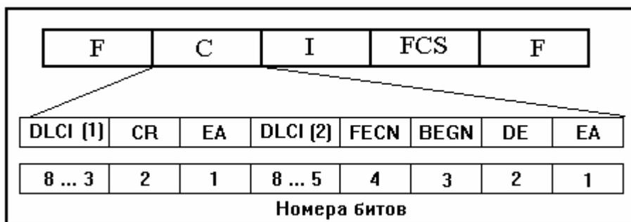
Рис. 9.8. Структура кадра frame relay
