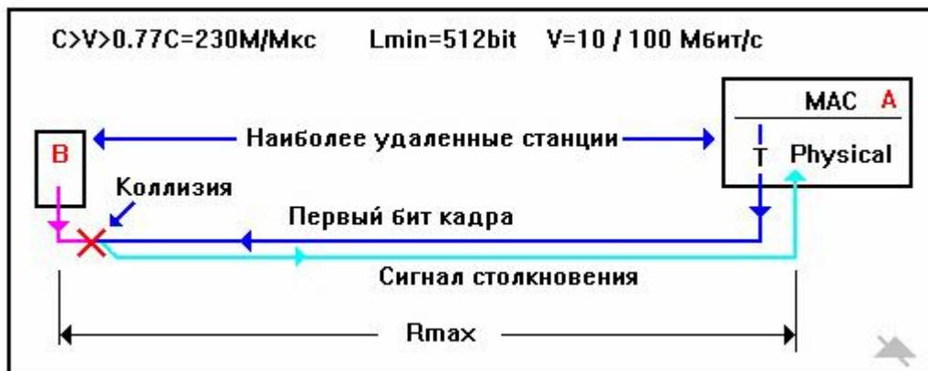
Рис 7.7. Технологические ограничения на максимальные расстояния
